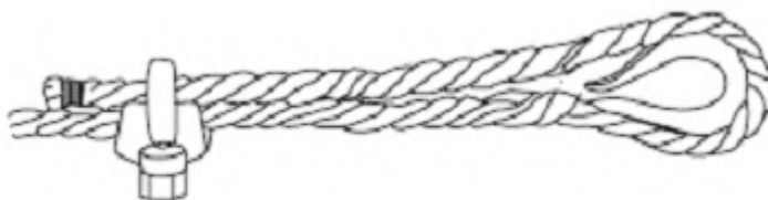
COLOCACION DE GRAPAS EN LAS GAZAS (Método de instalación de las grapas)
