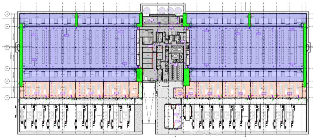
Figura 3. Vestíbulos de independencia en las uniones de las particiones sectorizadoras con las fachadas.
