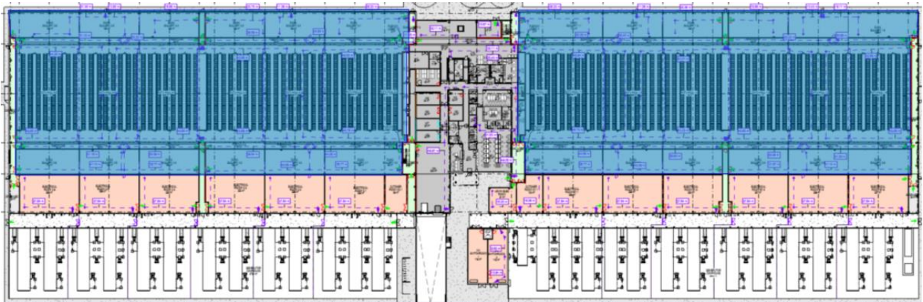
Figura 2. Diagrama de compartimentación de incendios.
