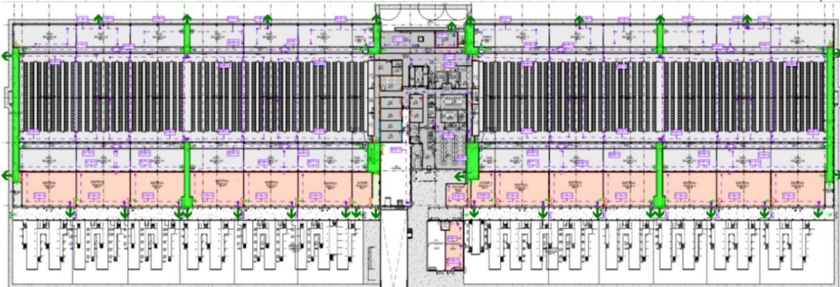
Figura 4. Salidas finales del edificio.
