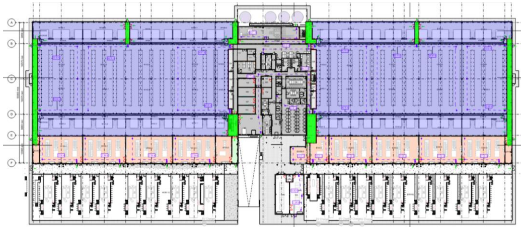
Figura 3. Vestíbulos de independencia en las uniones de las particiones sectorizadoras con las fachadas.
