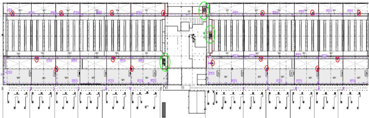
Figura 6. Ubicación de las escaleras de salida de la entreplanta de los Data Centers
