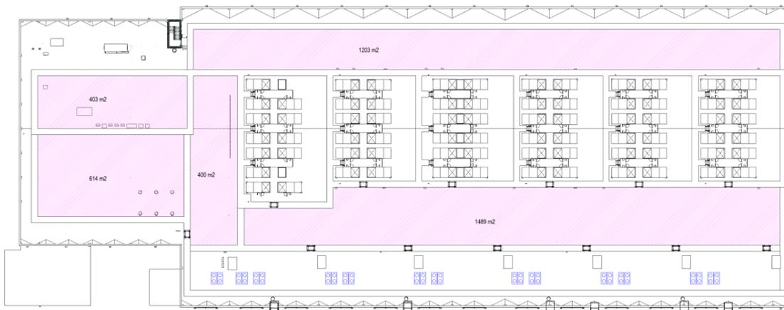
**Figura 16 Superficie de cubierta no transitable o accesible únicamente para conservación para el edificio B**
