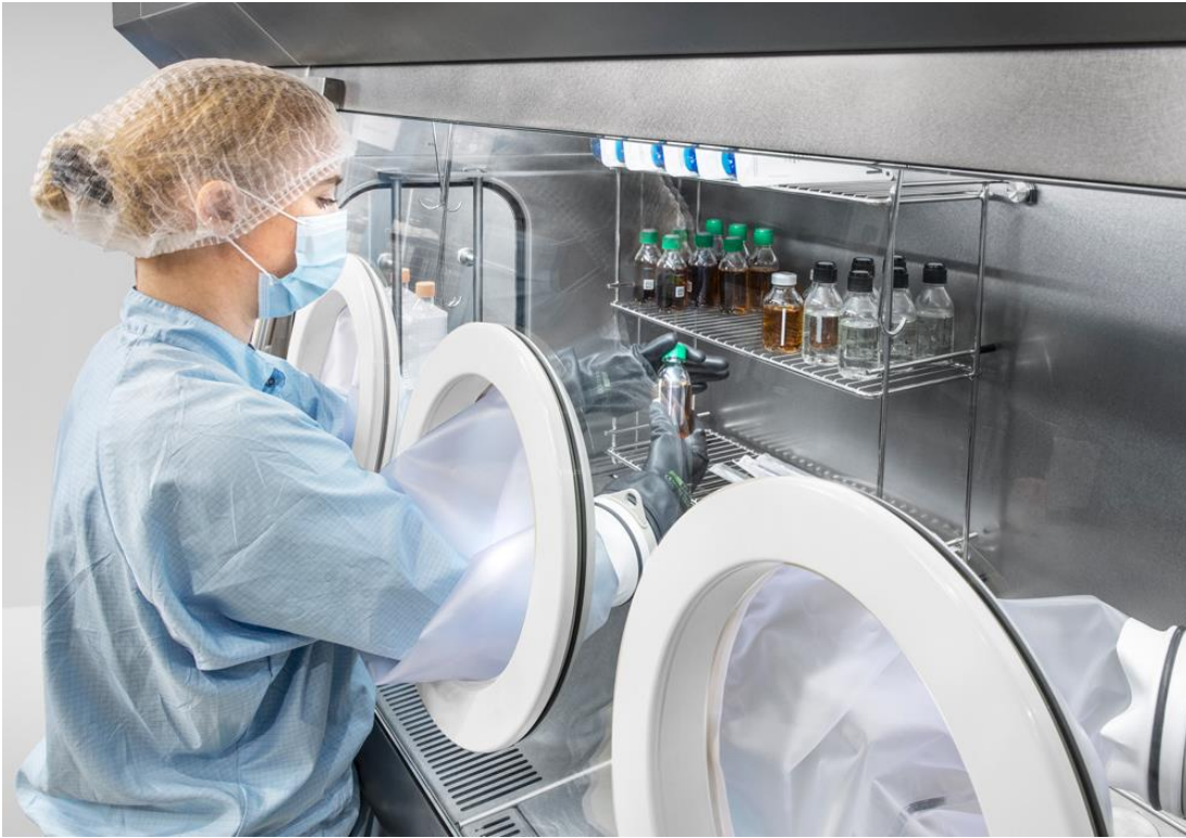
Imagen 2.11. Cabina de aislamiento de seguridad.
