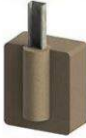
Imagen 19: Ejemplo de cimentación con perforación
