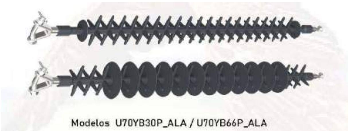
El modelo U70YB30P\_ALA para LAAT de hasta 30 Kv está provisto únicamente de aletas en estrella, que impiden la posada de las aves en la cadena pero que no tienen función dieléctrica, lo que permite una gran distancia de aislamiento sin incrementar excesivamente la línea de fuga.
