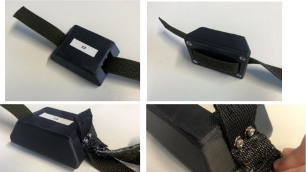
Figura 36. Colocación del Dispositivo electrónico sobre la Estructura de la cabezada (arriba). Conexión del Dispositivo electrónico con el Conjunto morro a través de los Ojales metálicos y los Tornillos conexión (abajo).
