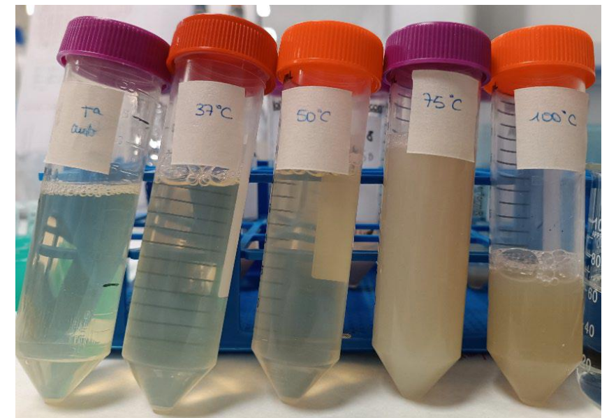
Proteína de soja purificada a distintas temperaturas. Cuanto más opaca es la muestra, más proteína disuelta tiene.
