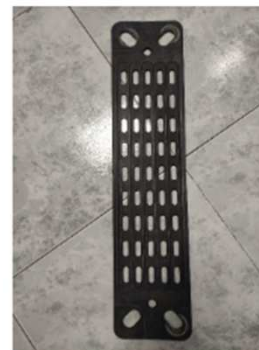
Unión larga sistema flotante. Con suciedad incrustada.
