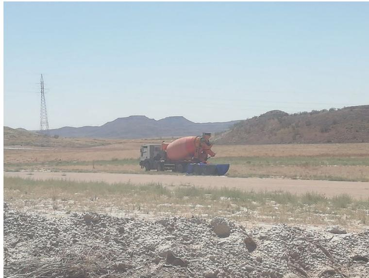
*Figura 1: Hormigonera lavando en contenedor.*
