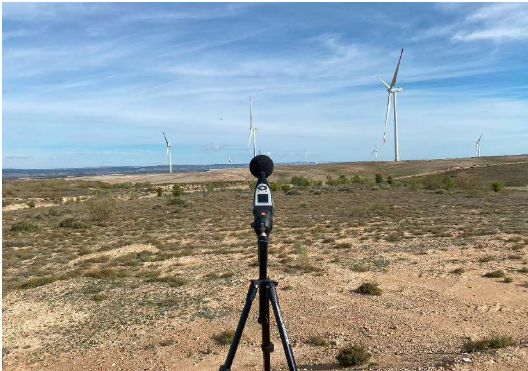
Foto nº2. Medición de ruido diurno en el punto de medición RPI-02, con PE Río Ebro II al fondo de la imagen.
