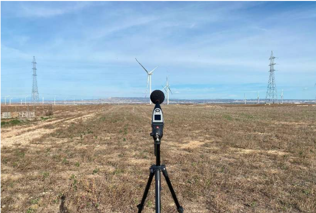
Foto nº4. Medición de ruido diurno en el punto de medición RPI-03, con PE Río Ebro II al fondo de la imagen.
