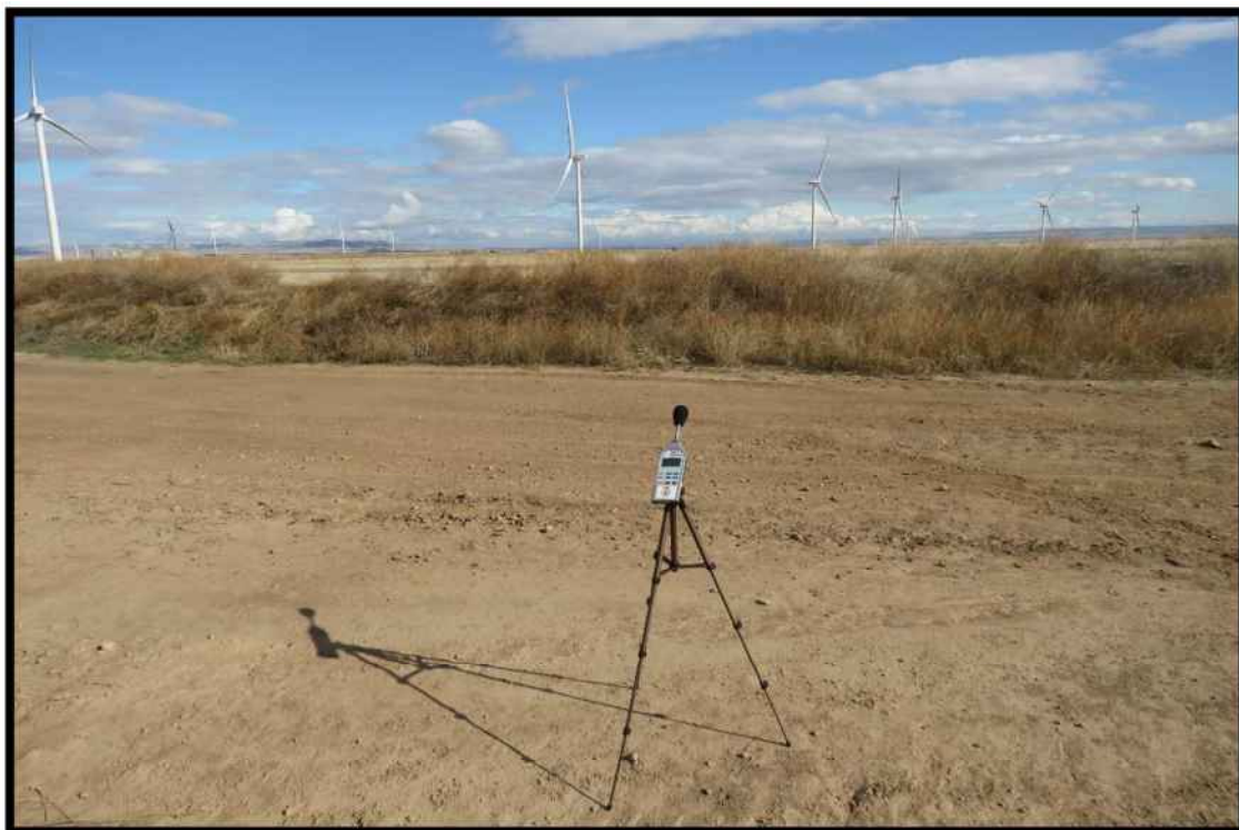
Imagen 22. Sonómetro y mediciones en PE Los Cierzos – La Nava.
