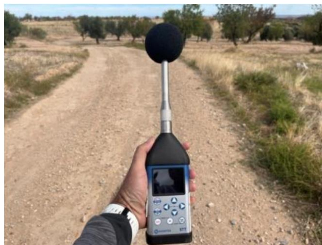
Figura 29: Sonómetro integrador modelo CESVA SC310 utilizado para la evaluación de los niveles de presión sonora en el parque eólico “El Tollo”.
