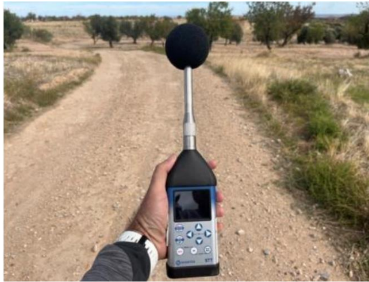
Figura 32: Sonómetro integrador modelo CESVA SC310 utilizado para la evaluación de los niveles de presión sonora en el parque eólico “El Llano”.
