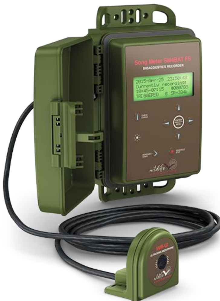
Figura 10: Detalle del dispositivo Song meter SM4 con su cubierta protectora abierta para mostrar la consola de programación y con un micrófono acoplado por cable.
