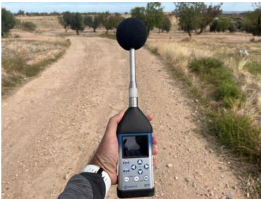
Figura 16: Sonómetro integrador modelo CESVA SC310 utilizado para la evaluación de los niveles de presión sonora en el parque eólico “Campo de Magallón”.
