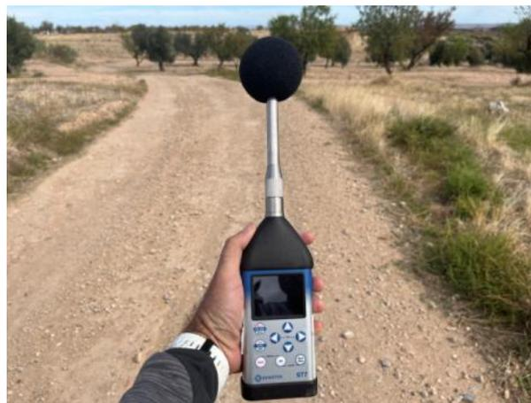
**Figura 43:** Sonómetro integrador modelo CESVA SC310 utilizado para la evaluación de los niveles de presión sonora en el parque eólico “Tinajeros”.
