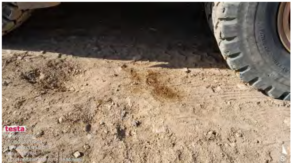
Maquinaria con fugas en campa de acopio.
