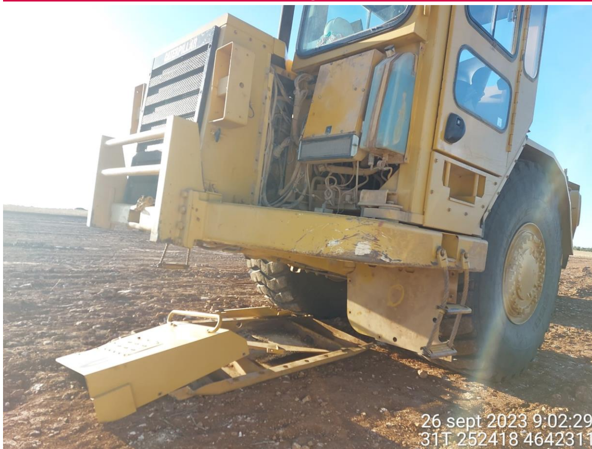
Imagen 1. Maquinaria pesada parada con la protección del suelo.
