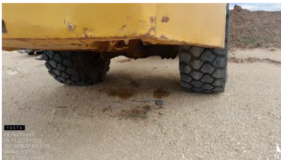
Fuga en camión aparcado en campa .
