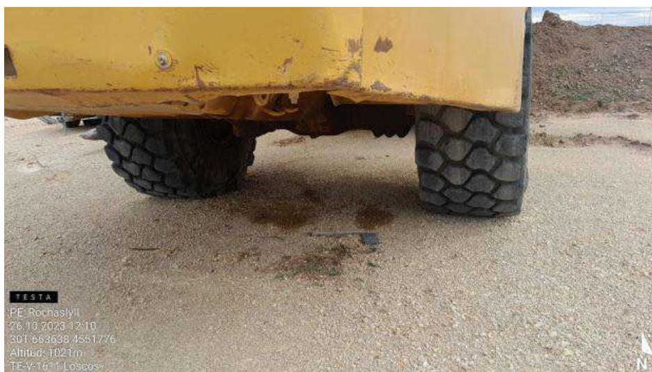
Fuga en camión aparcado en campa .
