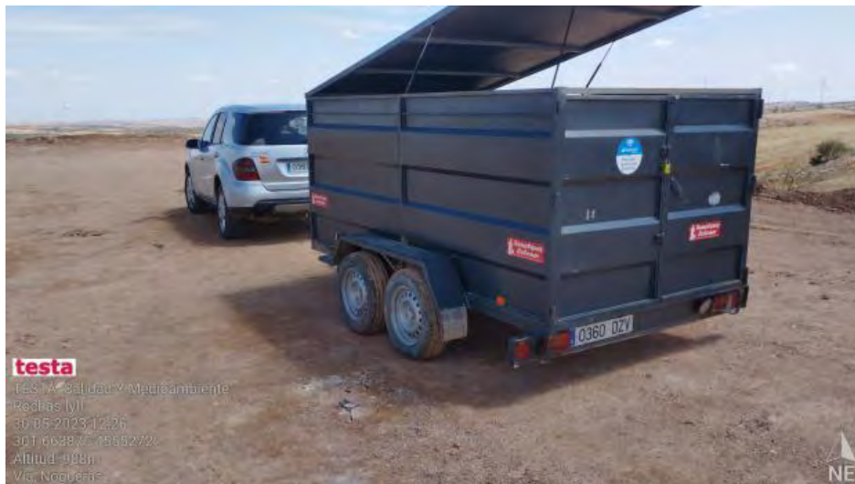
Maquinaria de repostaje sin protección de suelos
