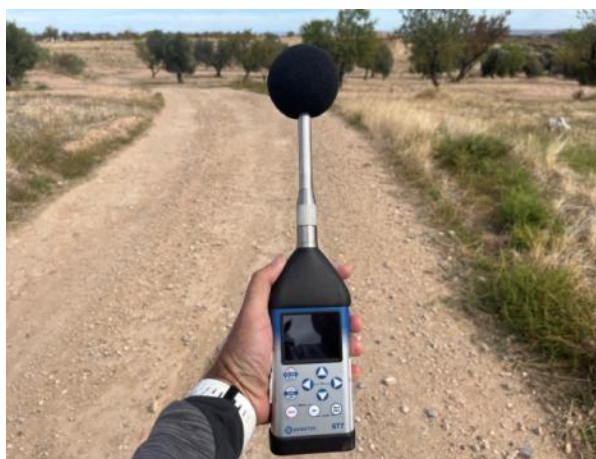
Figura 54: Sonómetro integrador modelo CESVA SC310 utilizado para la evaluación de los niveles de presión sonora en el parque eólico “Multitecnología”.
