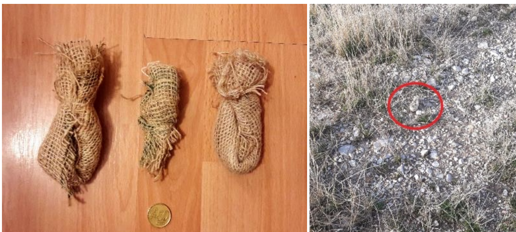
Figura 8: Ejemplo de señuelos empleados en el test de detectabilidad, y fotografía de uno de los señuelos ubicado en campo durante el test.
