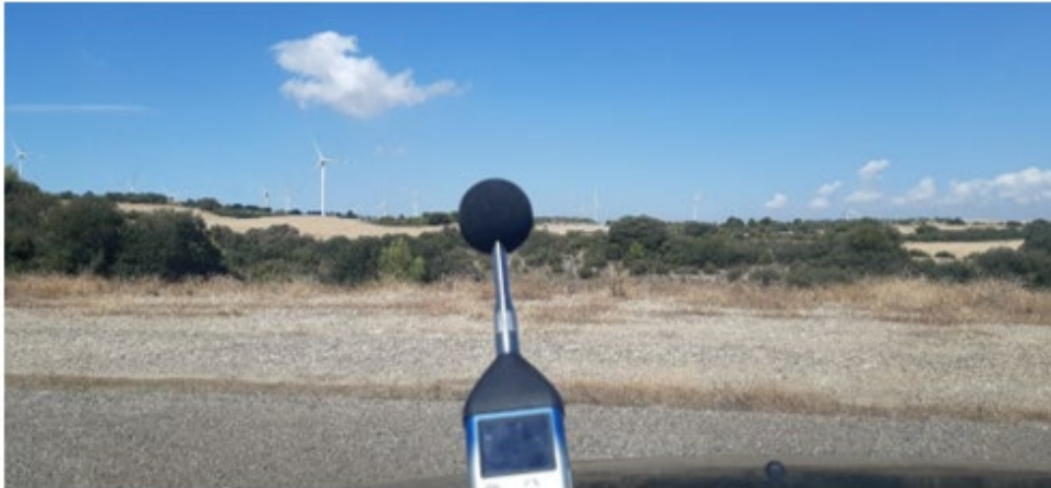
Medición acústica en ML5.06. Fuente: Elaboración propia
