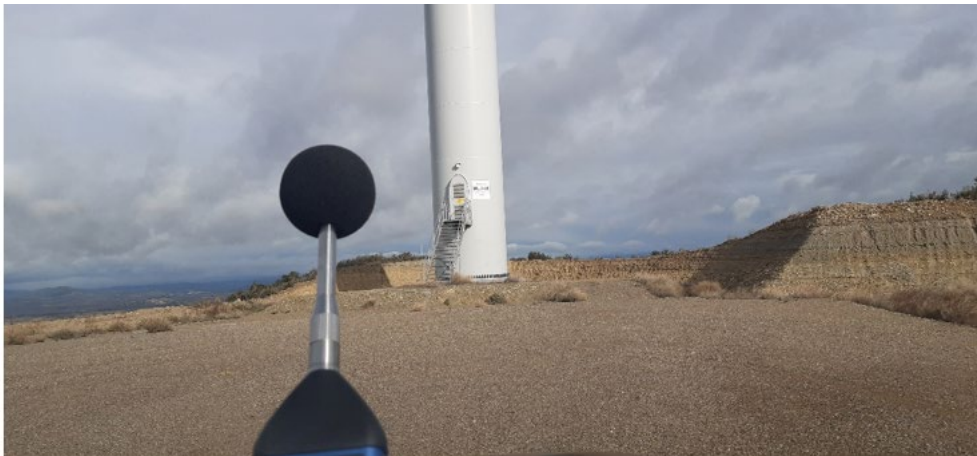
Medición acústica en ML3.08. Fuente: Elaboración propia
