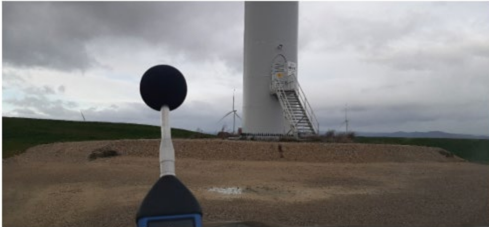
Medición acústica en ML1.10. Fuente: Elaboración propia
