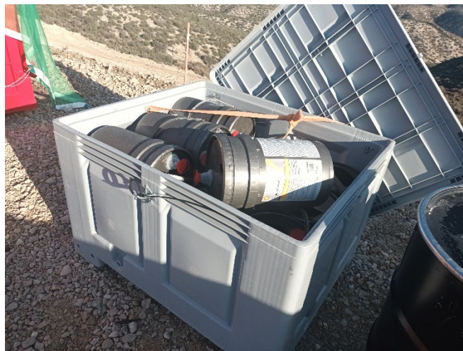
Figura 4: Contenedor de cubos de grasa sintética sin etiquetar ni cubrir
