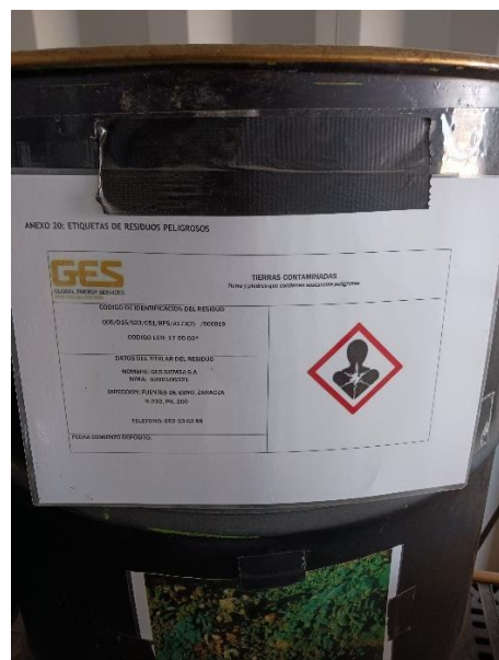
Figuras 3 y 4: Contenedor de tierras contaminadas correctamente identificado, sin fecha de inicio de envasado
