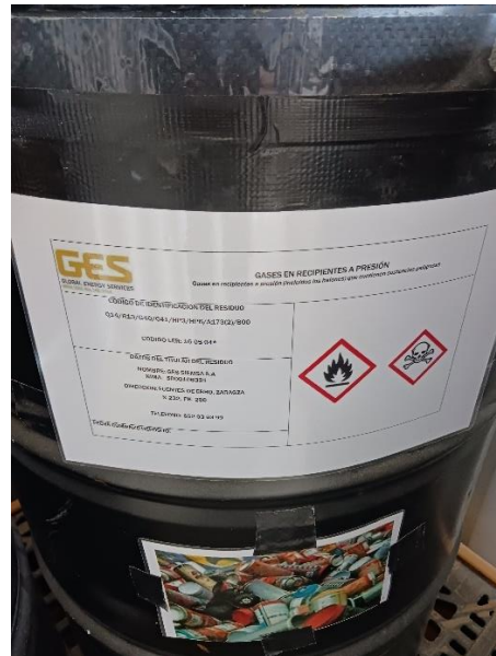
Figuras 1 y 2: Contenedor de aerosoles correctamente identificado, sin fecha de inicio de envasado.
