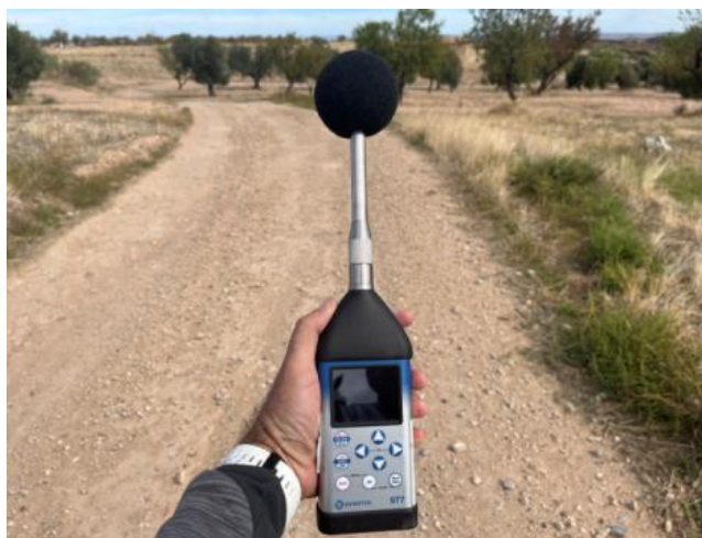
Figura 43: Sonómetro integrador modelo CESVA SC310 utilizado para la evaluación de los niveles de presión sonora en el parque eólico “Agón”.
