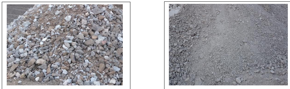
Figura 3. Izd. 1ª línea: machaqueo hormigón demolición. Derch. 2ª línea: machaqueo hormigón planta hormigón
