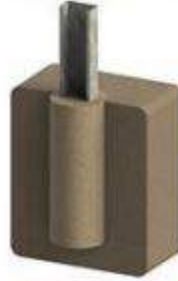
Imagen 19: Ejemplo de cimentación con perforación
