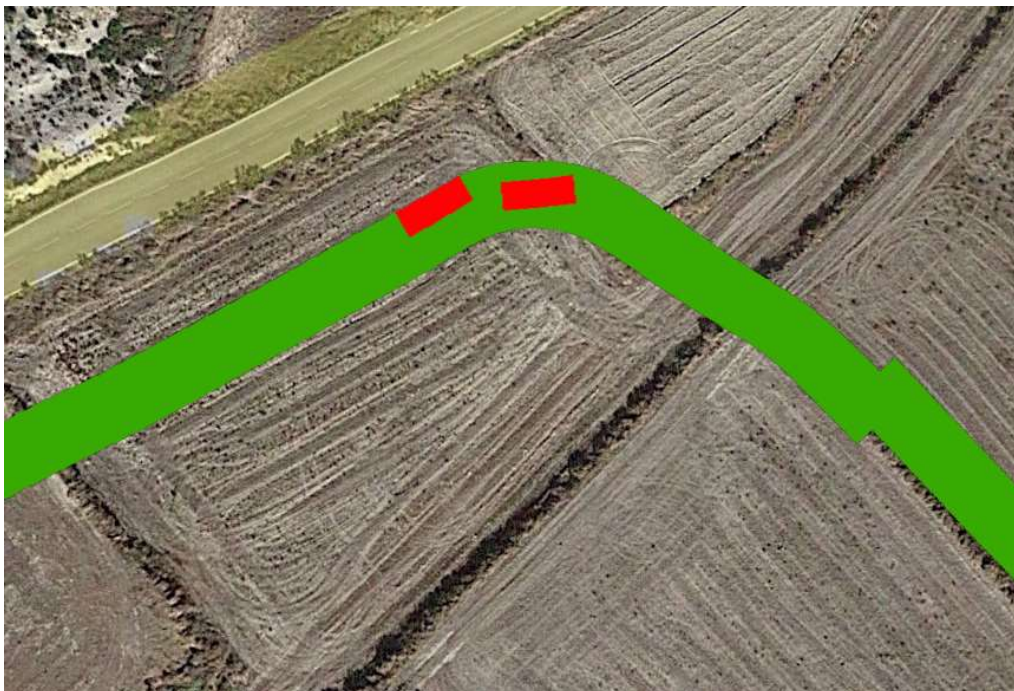
Imagen en planta de cámaras de empalme, definidas como Ocupación definitiva (indicadas en Rojo)
