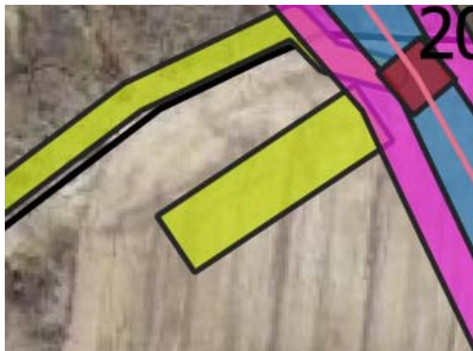
Fig. 4. Imagen de planta de ocupación temporal para accesos y construcción (en amarillo).
