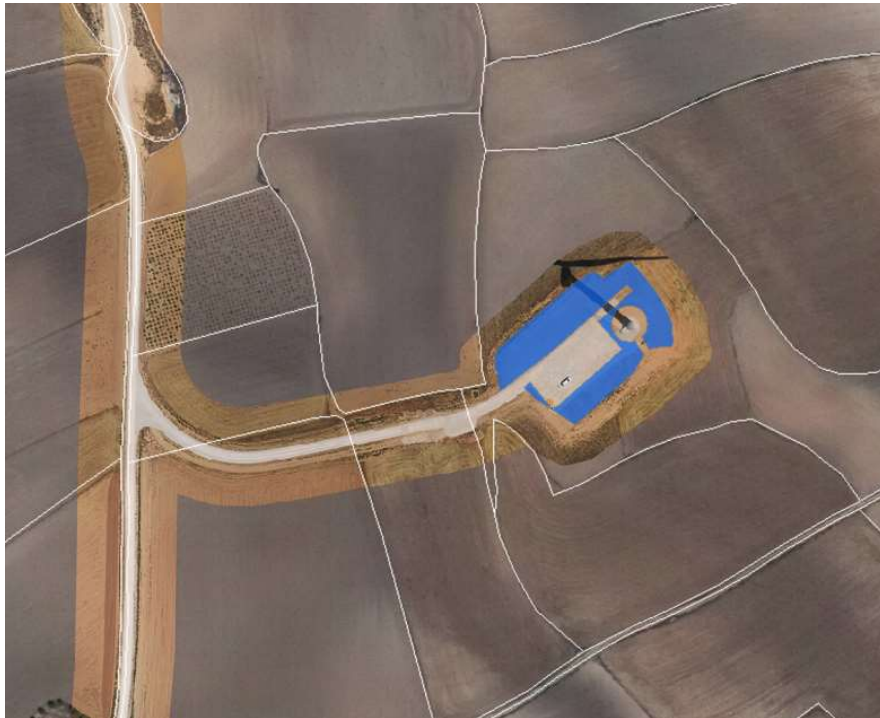
Imagen de plataforma de Baja Compactación (indicada en color Azul)
