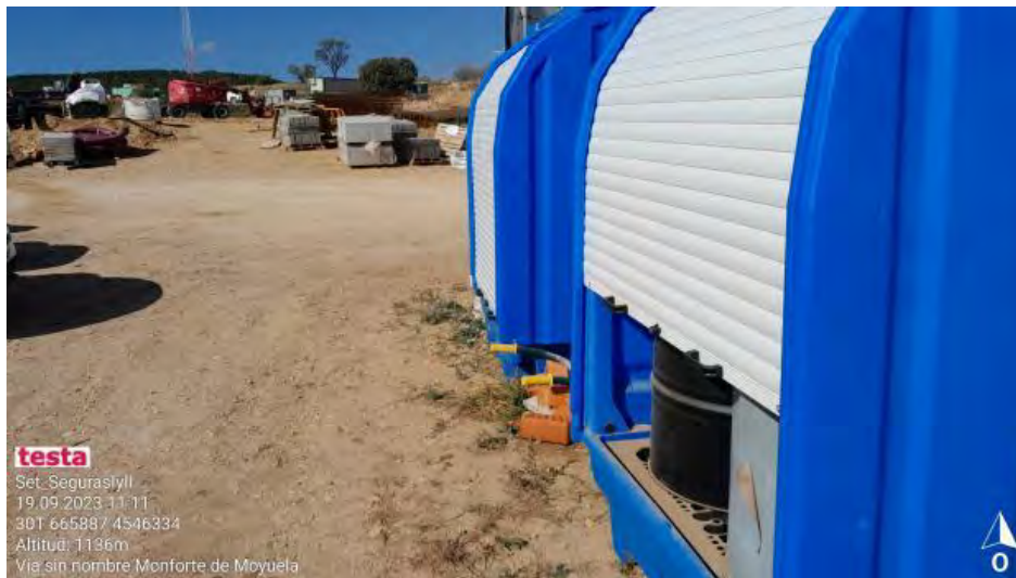
Contenedor RP sin cerrar
