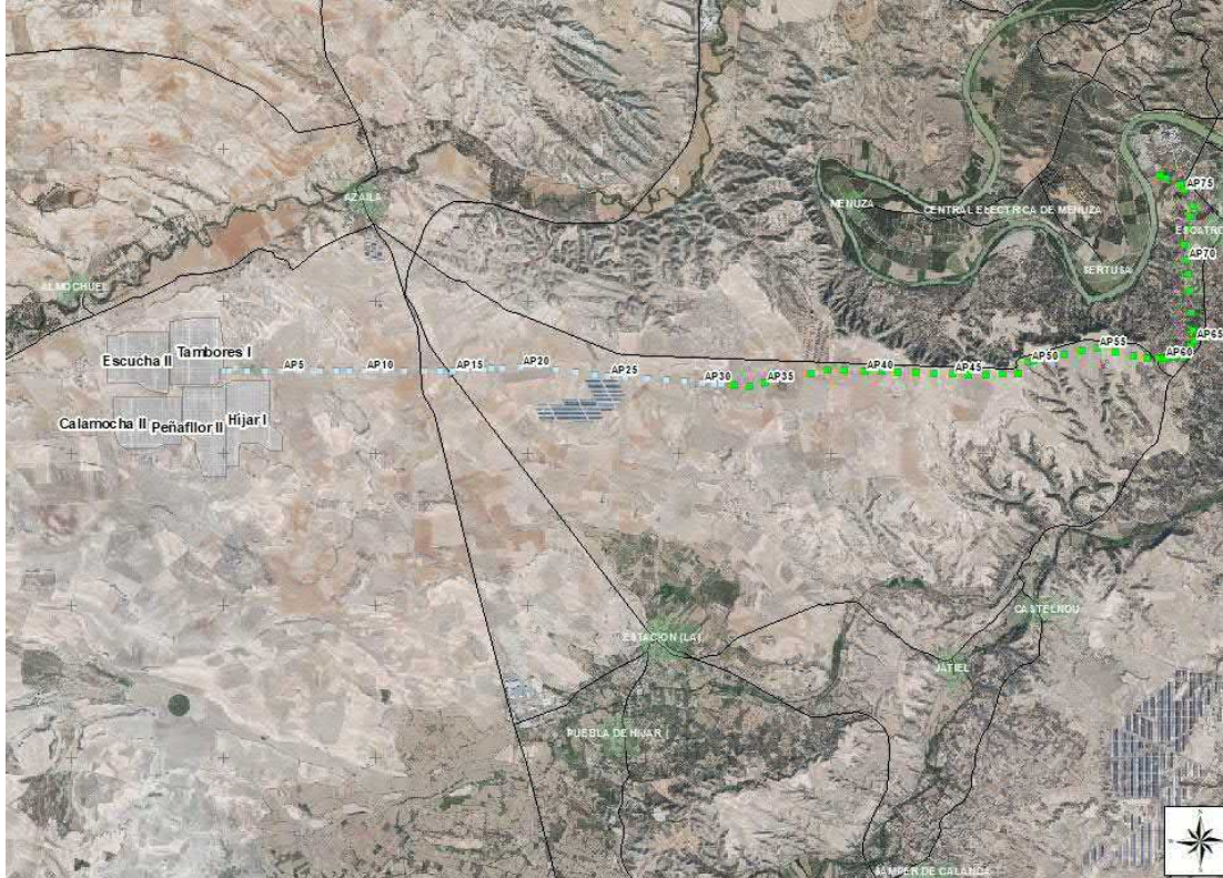
Figura 2. Emplazamiento de la LAAT 132 KV SET "Almochuel" - SET "Híjar" sobre ortofoto.
