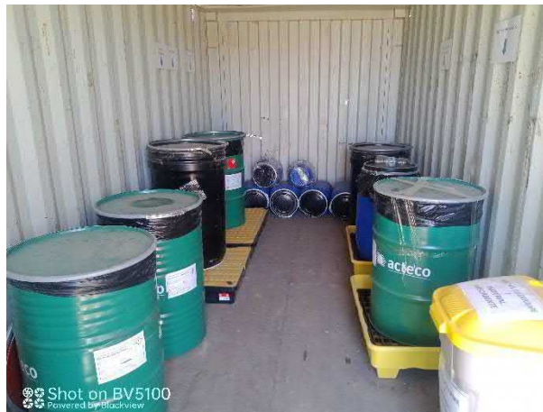
Imagen 9. Interior del punto limpio para el depósito de residuos peligrosos en contenedores homologados e identificados convenientemente conforme a la normativa vigente
