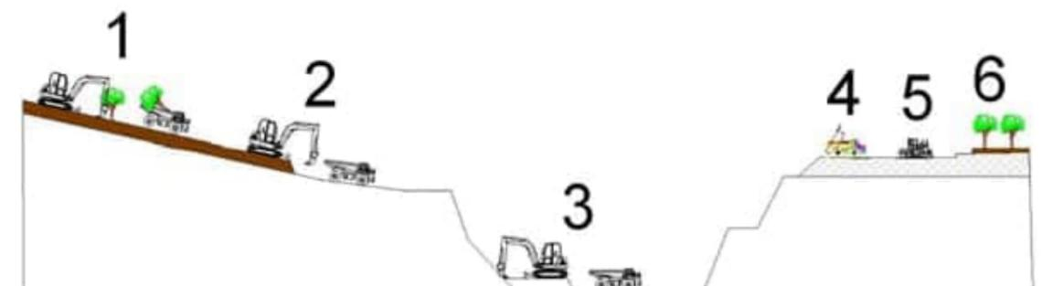
Figura nº 38. Esquema del proceso de explotación/restauración
