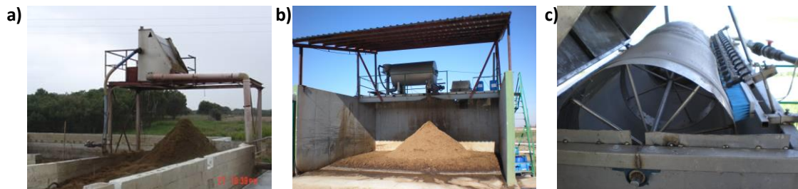
Figura 28. Imágenes de diferentes sistemas de tamizado: a) Tamiz estático en una granja de vacuno; b) y c) tamices rotativos. M.C. García. Proyecto LIFE+ MANEV, 2015.
