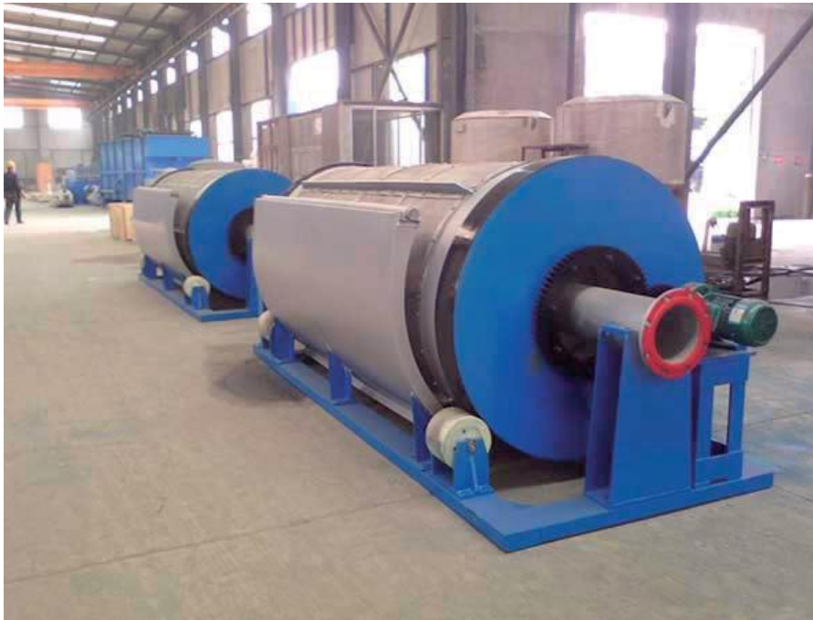
Figura 33. Unidades de microfiltros rotativos.
