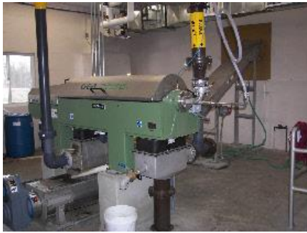
Figura 26. Imagen de un decantador-centrífuga y esquema de funcionamiento adaptado de Moller et al. (2007).
