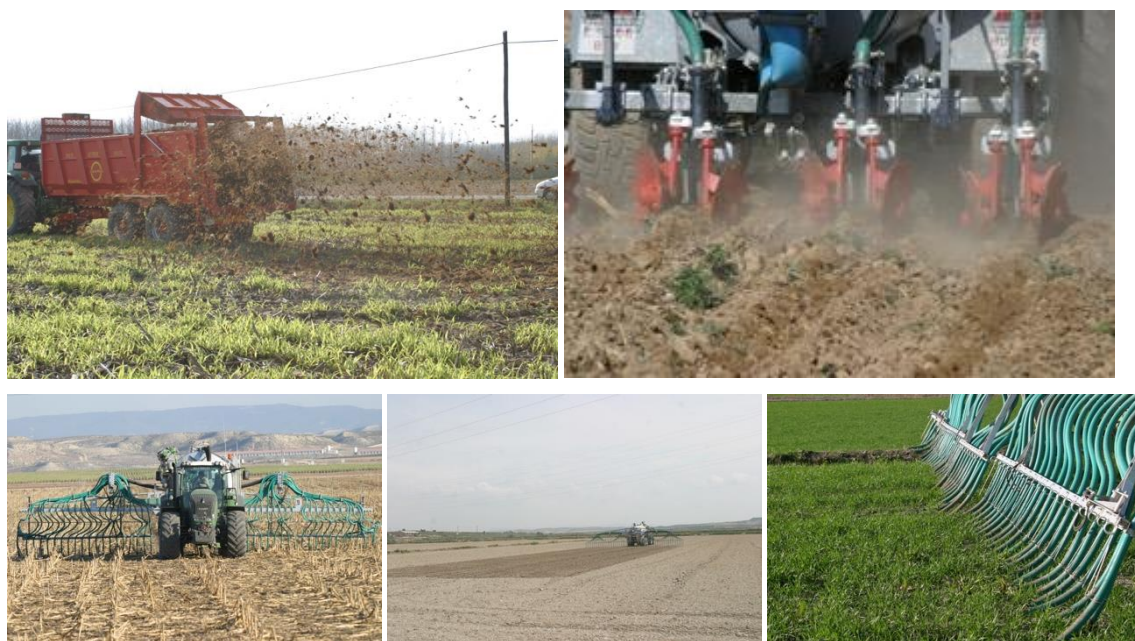
Figura 23. Imágenes de diferentes sistemas de aplicación de estiércol sólido y purín.
