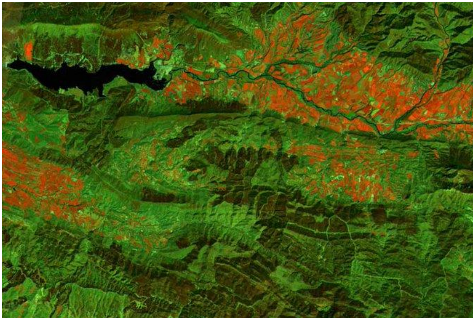
Satélite Landsat8. Entorno de Yesa (Zaragoza). Año 2017. Detalle de composición de falso color 564
