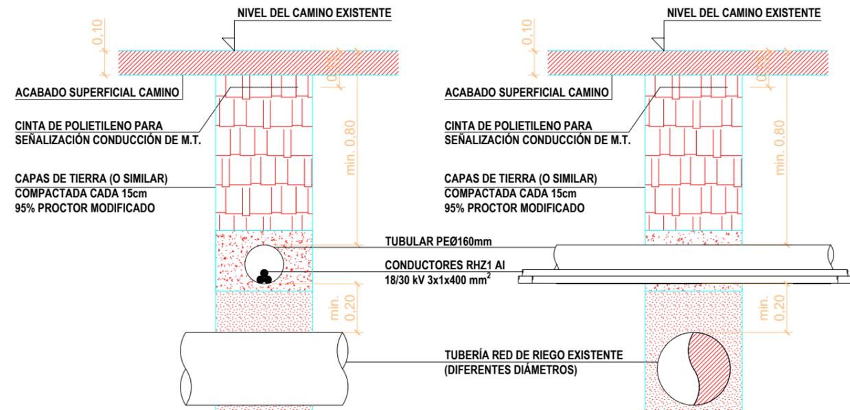
EN CASO DE IR PARALELOS EL TRAZADO DE LA TUBERÍA DE LA RED DE RIEGO Y LA LÍNEA DE MEDIA TENSIÓN SE MANTENDRÁ UNA DISTANCIA MÍNIMA DE 0,20m EN PROYECCIÓN HORIZONTAL. LA CANALIZACIÓN DE AGUA QUEDARÁ POR DEBAJO DEL NIVEL DEL CABLE ELÉCTRICO.
