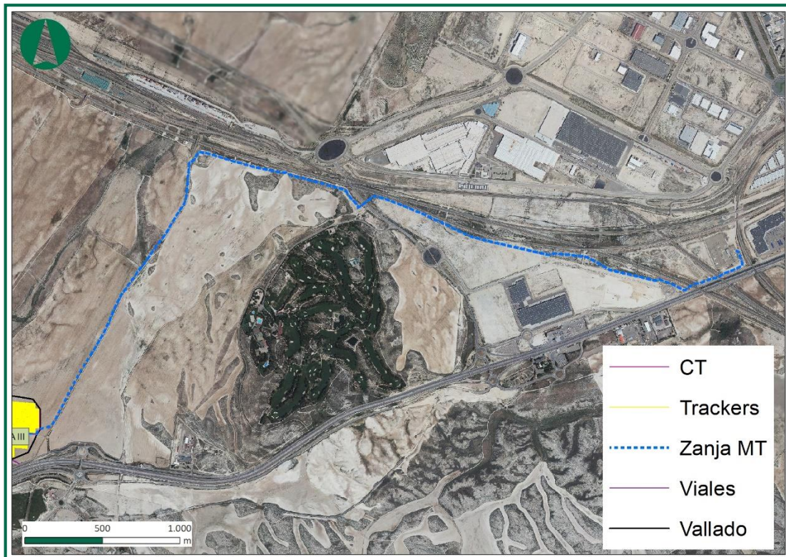
Figura 5. Implantación de la zanja de media tensión para evacuación
