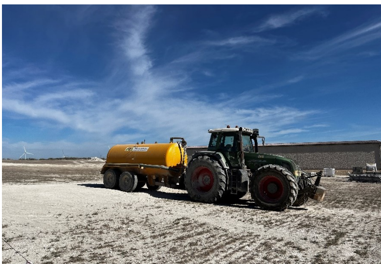
Figura 2 Cuba para la realización de riegos
