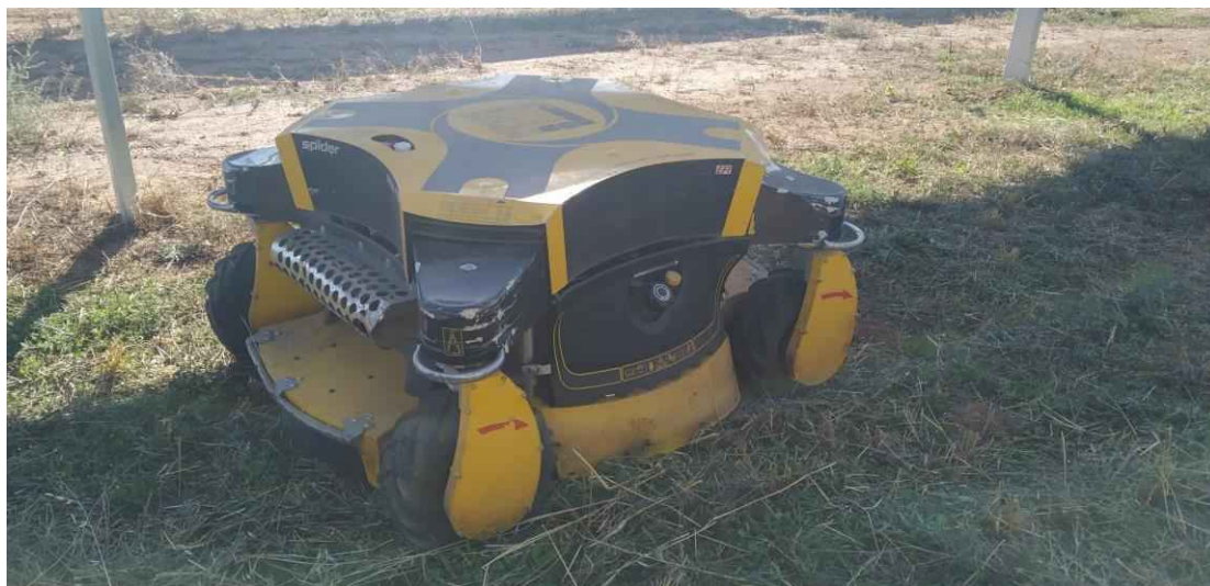
Foto 23. Desbrozadora spider para el control de la cubierta vegetal bajo seguidores.
