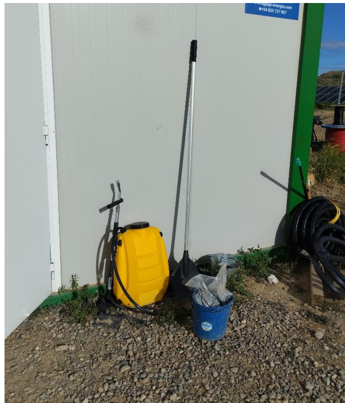
Mochila con agua y batefuegos, en la campa de obras
