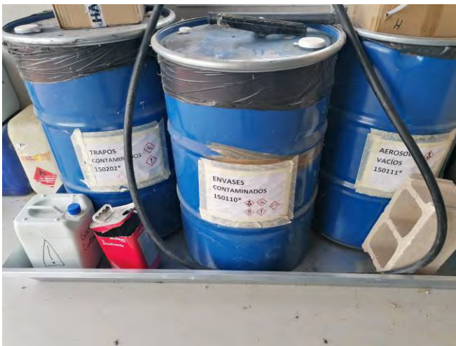
Fotografía 35.- Gestión de residuos: Bidones-contenedores etiquetados. Octubre.
