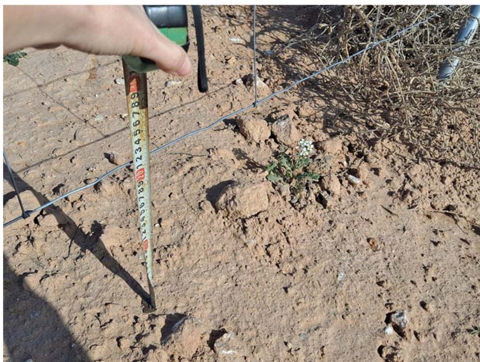
Figura 8.2. Paso inferior de fauna con altura de 20 cm
