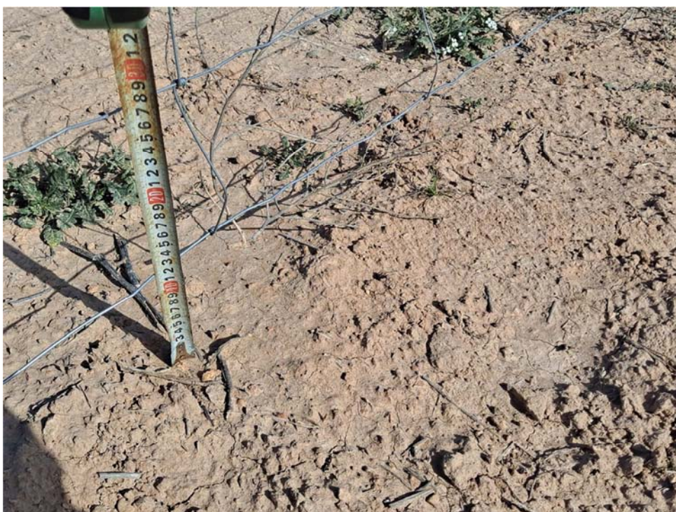
Figura 8.3. Paso inferior de fauna con altura menor a 20 cm como consecuencia del extendido de la tierra vegetal acopiada
