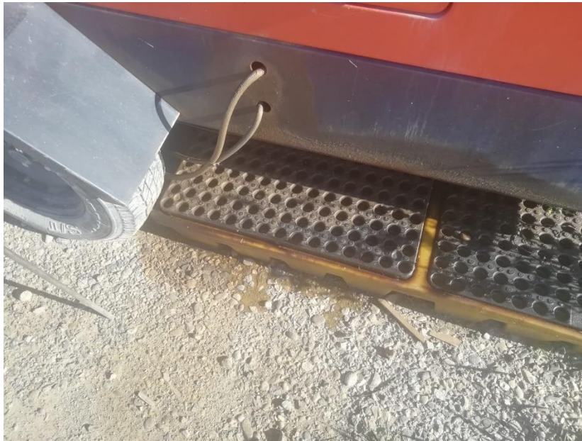
Fig. 1. Derrame de fluidos contaminantes.
