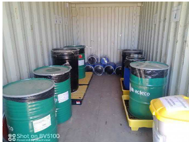
Imagen 26. Depósitos homologados adecuadamente identificados situados en el interior del punto limpio para el depósito temporal de residuos peligrosos
