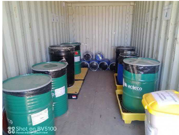
Imagen 25. Depósitos homologados adecuadamente identificados situados en el interior del punto limpio para el depósito temporal de residuos peligrosos
